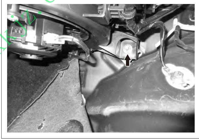
20. 掀开部分地毯，拆卸空调加热器搭铁线束 1 个螺栓
