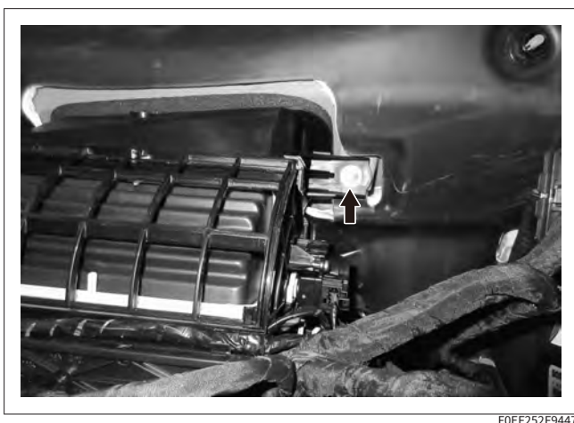
19. 掀开部分地毯，拆下空调器总成右下侧 1 个螺母
